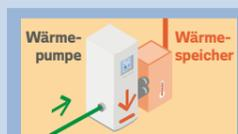
2 Die Wärmepumpen verbrauchen den überschüssigen Windstrom und erzeugen daraus Wärme.
