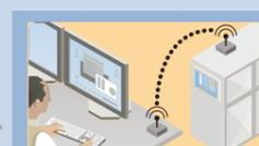
1 Die Wärmeleitwarte steuert Gebäude mit Blockheizkraftwerken über die Funkverbindung an.
