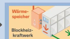
2 Die Blockheizkraftwerke produzieren Strom und Wärme. Der Strom geht ins Netz und erhöht die Netzlast.
