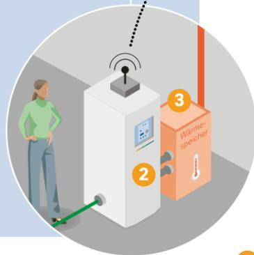
Im Virtuellen Kraftwerk von Vattenfall werden dezentrale Energieerzeuger wie Blockheizkraftwerke und Energieverbraucher wie Wärmepumpen zu einer Einheit zusammengeschlossen und zentral gesteuert.
